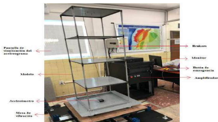
Figura 6. Componentes de la mesa de vibración
