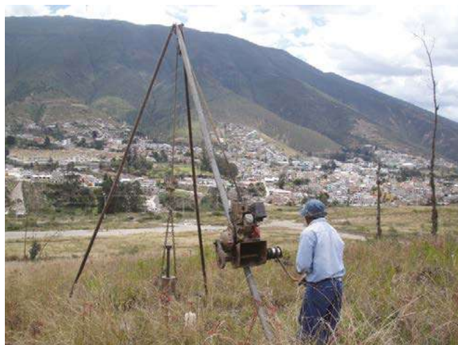
Figura 13. Equipo ensayo SPT. Manzana 22, Ciudad Bicentenario
